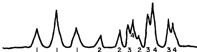
^{31}P -NMR.-Spektrum des Octylphosphin-Gemisches, erhalten durch Reduktion von Octylphosphonsäuredichlorid (dargestellt nach [5]) mit LiAlH_4
